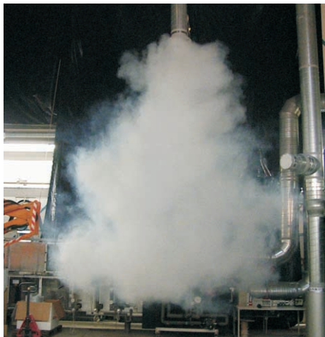
Bild 3: Strahlausbreitung für Kühl- und Heizfall durch Rauchprobe sichtbar
