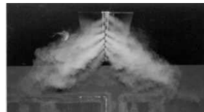
Bild 6: Luftstrahlausbildung durch Rauchprobe sichtbar gemacht
