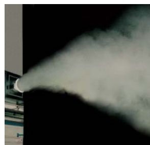
Luftstrahlausbildung SW Strahlrichtung leicht nach oben (Kühlfall)
