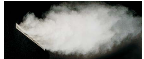
Luftstrahlausbildung, Typ WSD Oben: Luftstrahl horizontal Links: Luftstrahl schräg nach oben und nach unten gerichtet
