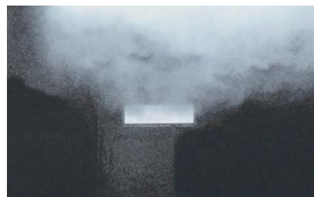
Luftstrahlausbildung, Typ BF, Strahlrichtung asymmetrisch
