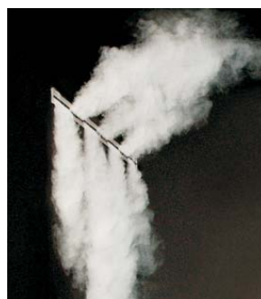
Luftstrahlausbildung, Typ WSD Oben: Luftstrahl horizontal Links: Luftstrahl schräg nach oben und nach unten gerichtet
