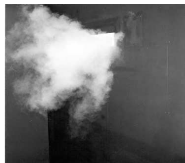
Strahlausbildung durch Rauchprobe sichtbar
