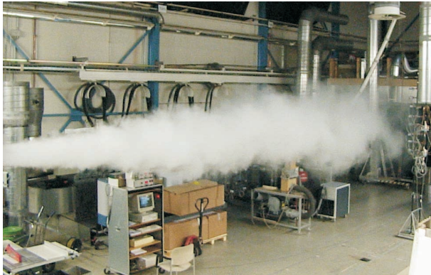
Bild 3: Strahlausbreitung der Weitwurfdüse
