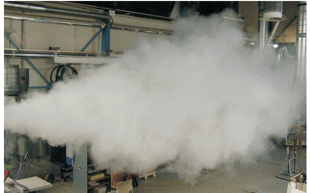
Bild 4: Strahlausbreitung der Dralldüse
