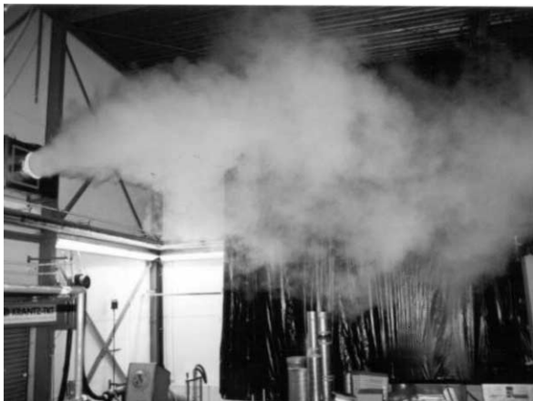
Strahlausbreitung im Kühlfall
