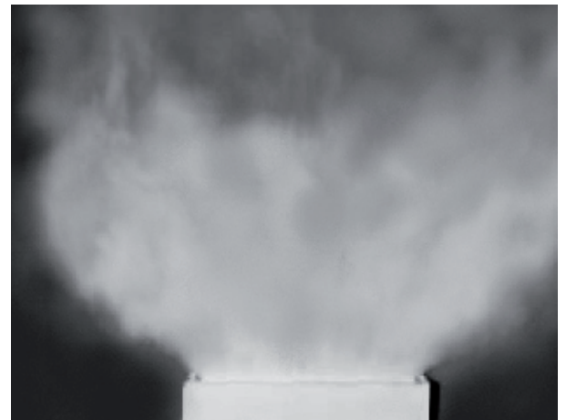
Bild 3: Blick zur Fassade, Strömung schematisch und durch Rauch sichtbar gemacht
