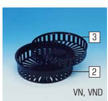
12 Verteilkorb Niedrige Ausführung Korboden offenbar. Dadurch zusätzliche Lufteströmung von unten, vorzugsweise für Doppelböden mit dickeren Platten und kleineren Druckraumhöhen, mit Drosseleinrichtung: Typ VND (ohne Drosseleinrichtung: Typ VN); lieferbar für Baugröße DN 200
