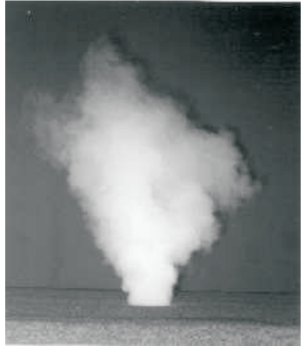
Bild 5: Strahlcharakteristik Bodendrallauslaß durch Rauchprobe sichtbar
