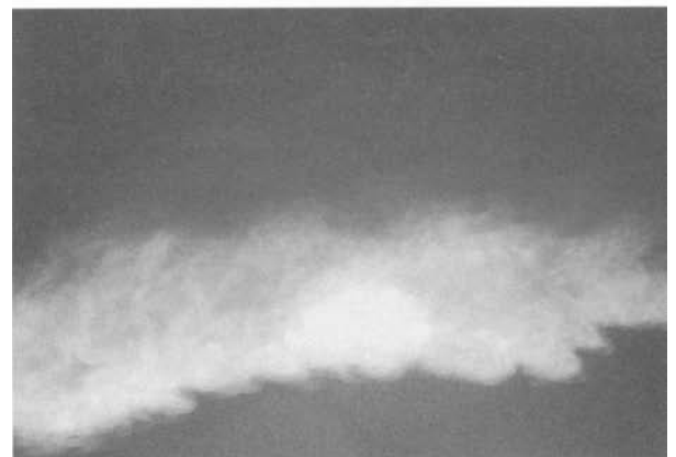
Bild 6: Turbulenzarme, waagerechte Strahlausbreitung durch Rauchprobe sichtbar gemacht; die Bilder zeigen die Luftströmung zu verschiedenen Zeiten nach Austritt aus dem Bodenquellauslass
