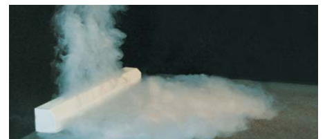
Luftstrahlausbildung Q-SH (im Heizfall)
