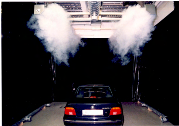
Bild 4: Halbtrapezförmiger Verdrängungsauslass in einem Versuchsraum der Automobilindustrie
