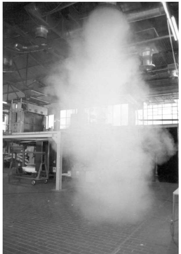
Bild 8: Vertikales Ausblasen aus großer Höhe, Strahl- ausbreitung durch Rauchprobe sichtbar gemacht; oben: Kühlfall, Kernrohr geschlossen, unten: Heizfall, Kernrohr offen.
