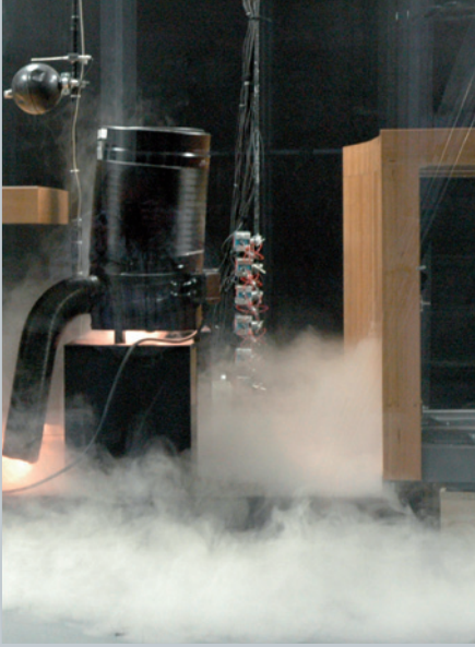
Laboruntersuchung Quelllüftung in einem Parlament (Landtag NRW Düsseldorf)
