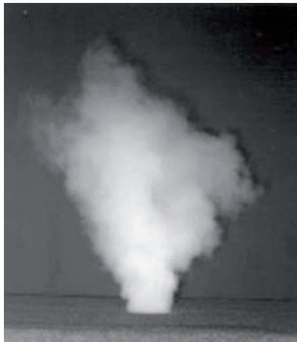
Bild 5: Strahlcharakteristik Bodendrallauslass durch Rauchprobe sichtbar
