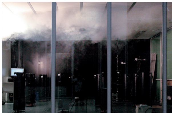
Bild 8: Stellung Kühlfall, Zulufttemperatur 16 bis 21 °C
