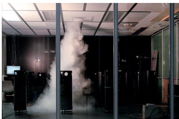
Bild 10: Stellung Aufheiz-Fall, Zulufttemperatur 27 bis 30 °C
