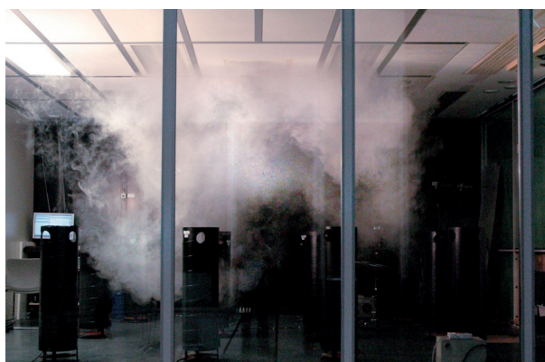
Bild 9: Stellung Dauerheiz-Fall, Zulufttemperatur 22 bis 26 °C
