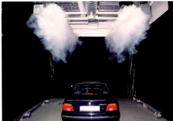
Bild 7: Halbtrapezförmiger Verdrängungsauslass in einem Versuchsraum der Automobilindustrie
