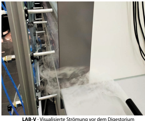
LAB-V - Visualisierte Strömung vor dem Digestorium
