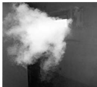
Strahlausbildung durch Rauchprobe sichtbar
