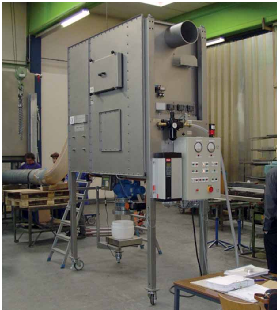
Werksabnahmeprüfung im Fertigungsstätte M-RHF | hightec 2x1 RH13-1x1 H13
