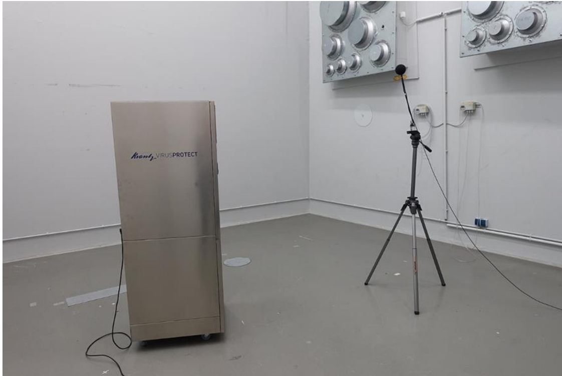
Bild 4-1: Versuchsaufbau zur Schalldruckmessung nach DIN EN ISO 3741
