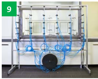
Einrichtung zur Probenahme vor dem Abzug
