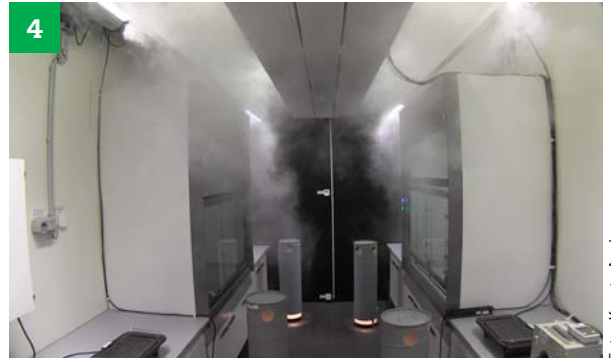
Strömungsvisualisierung Multifunktionales Labormodul (Krantz Aachen)
