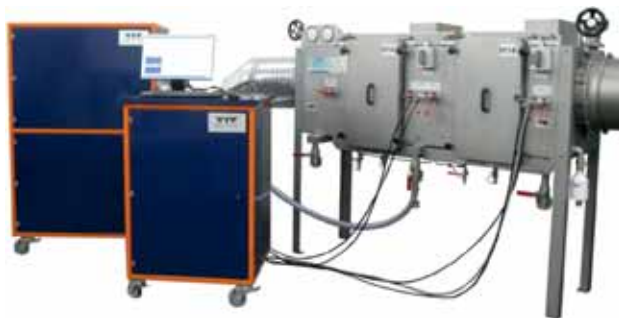
Abb. 1: Filteranlage mit Filterstufen 1 und 2 mit Messwagen (Quelle alle: YIT GmbH).
