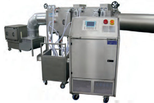
Abb. 3: Begasung der Filteranlage mit Filterstufen 1 und 2 über Haupt- und Bypass-Anschlüsse. (Quelle: Caverion Deutschland GmbH, Krantz Filter- und Absperrsysteme).
