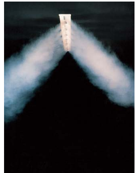
Abb.4 Strahlcharakteristik beim Luftdurchlass IN-V3
